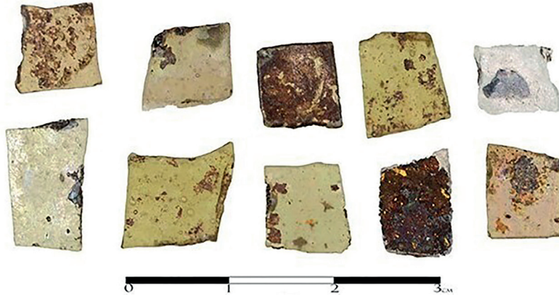
Figure 8 The Detached Top Layer of Gold Leaf Glass Tesserae / Altın Varaklı Cam Mozaik Parçalarının Ayrılmış Üst Katmanı
